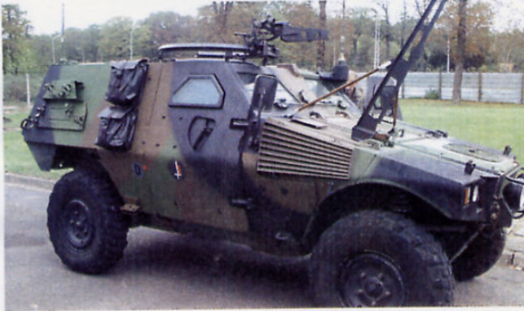
Ainsi protégé, ce véhicule peut résister aux engins explosifs improvisés. With this protection, the vehicle can withstand Improvised Explosive Devices.
